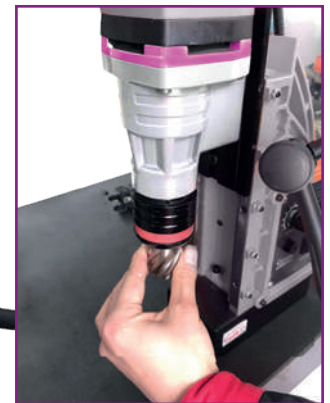
Modèle DM 35PF · Mandrin à changement rapide de série
