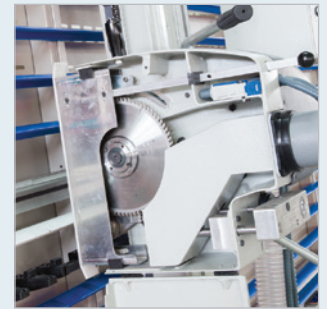
• Grande ouverture pour un changement de lame de scie simple et rapide
