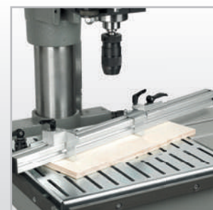
• Application particulière : butée d'arrêt
