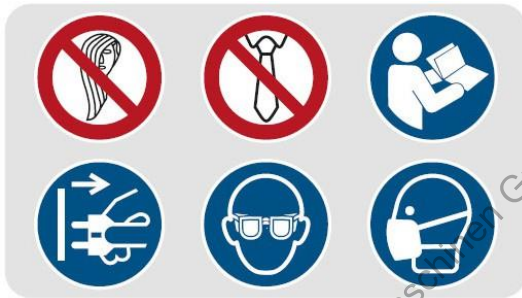
Fig. 1-1: Signalisation de sécurité - signal d'interdiction : Utilisation interdite avec les cheveux longs, utilisation interdite avec une cravate | Signes d'obligation : Respecter le mode d'emploi, débrancher la fiche secteur, utiliser une protection oculaire, utiliser une protection respiratoire | Signes d'avertissement : Avertissement de blessure à la main, Avertissement de tension électrique
