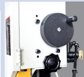
• Guide-lame ajustable en hauteur par volant (sur VMBS 2013 I et VMBS 2013 IE)
