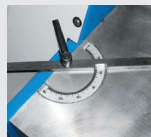
• Butée angulaire réglable avec échelle graduée (livrée de série)
