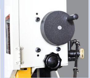
• Guide-lame ajustable en hauteur par volant (sur VMBS 2012H et VMBS 2012HE)
