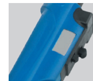
Fig. : Torche R-TIG avec fonction Up/Down
