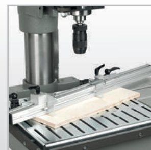
• Application particulière : butée d'arrêt
