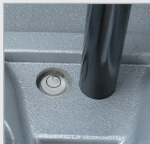
RB 127 • Niveau à bulle intégré
