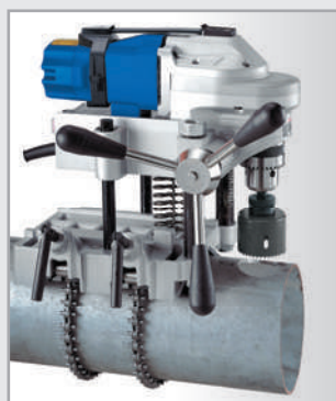
RB 127 • Support pour tuyaux de 32 à 203 mm
