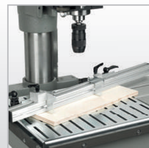
• Application particulière : butée d'arrêt
