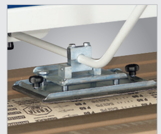
Fig. : Sabot coulissant avec plaque graphite
