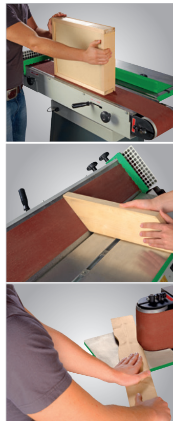
Unité de ponçage avec réglage d'inclinaison en continu de 0° à 90° pour poncer verticalement et horizontalement
