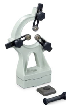
Fig. : Lunette fixe DB 900/1100 • Indispensable lors du travail des pièces dont la longueur est trop importante ou le diamètre trop faible pour les usiner en "montage en l'air" • Permet d'empêcher les vibrations et les marques de broutages sur la pièces à usiner en rotation
